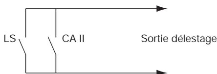
**!** La sortie rebascule à 0 en cas de disparition de l'alimentation. Il est donc préférable de mettre en parallèle avec le relais LS le contact de position de la source secours (2). Ceci afin de ne pas délester en cas de disparition de la source secours.
