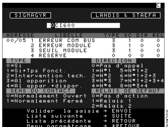
L'écran ci-dessous permet de paramétrer les quatre entrées contact raccordées sur l'OCI600.
