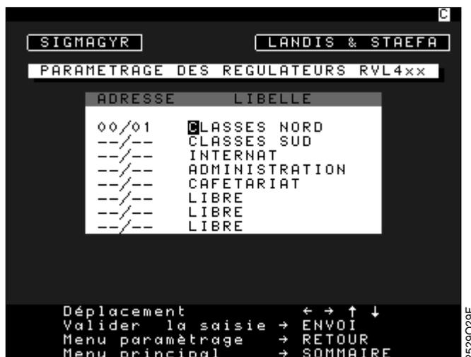
L'adresse des RVL série 400 est automatiquement affichée dans les champs de gauche en fonction du nombre de régulateurs raccordés sur le bus.
