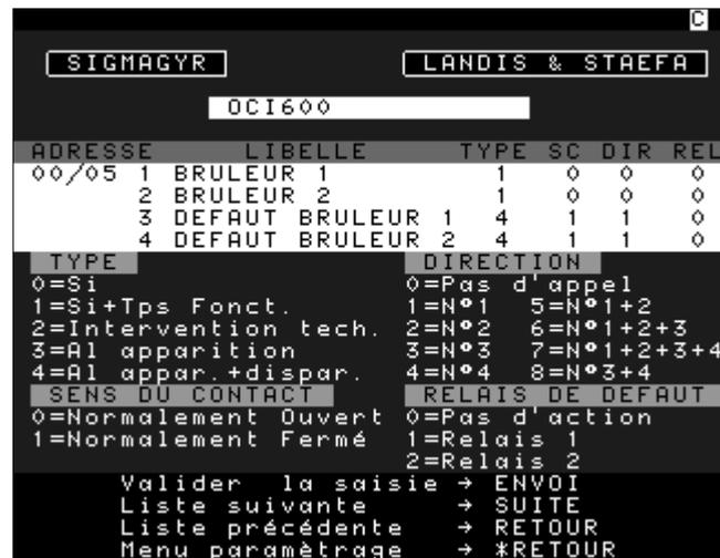
L'écran ci-dessous permet de paramétrer les quatre entrées contact raccordées sur un module.
