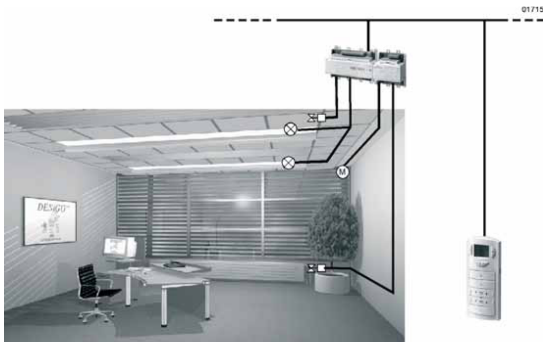
Commande intégrée de la régulation CVC, de l'éclairage et des stores avec DESIGO™ RXC
