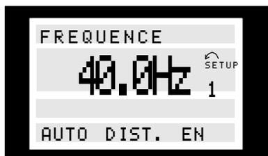
La ligne 2 indique la fréquence de sortie du courant et la configuration active.
