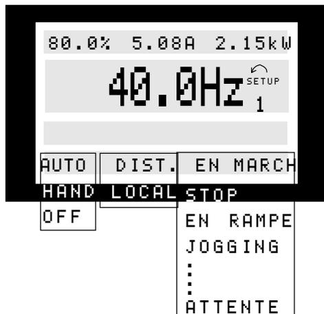
La partie gauche de la ligne d'état indique l'élément de commande actif du variateur de vitesse VLT. AUTO signifie que le contrôle se fait par les bornes de commande, alors que HAND signifie que le contrôle se fait par les touches locales sur le panneau de commande.
